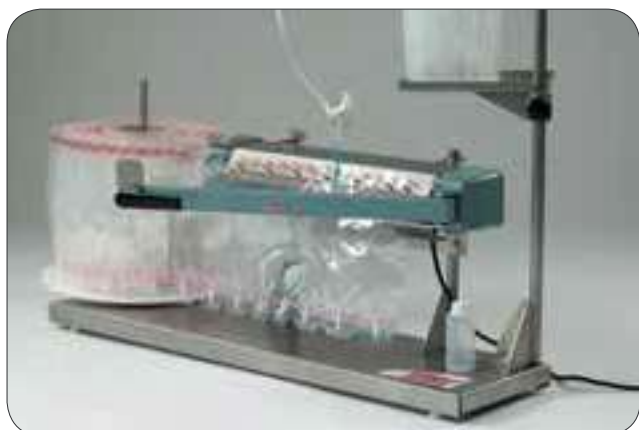
Ref. 022267 Envasadora manual GTB 250 Máquina envasadora y selladora manual. El flujo del semen se controla manualmente mediante un clamp. La velocidad de llenado es de 250 bolsas GTB por hora.
