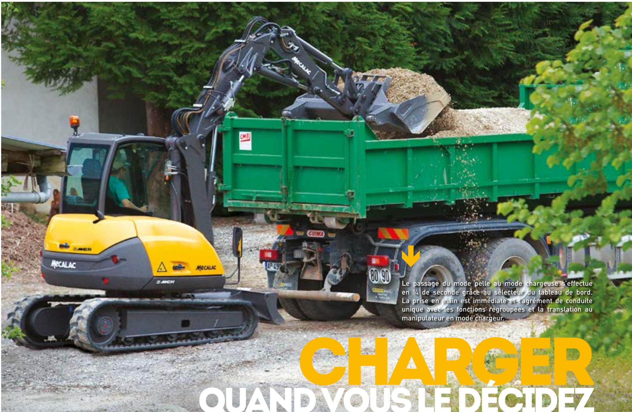
Le passage du mode pelle au mode chargeuse s'effectue en ¼ de seconde grâce au sélecteur du tableau de bord. La prise en main est immédiate et l'agrément de conduite unique avec les fonctions regroupées et la translation au manipulateur en mode chargeur.
