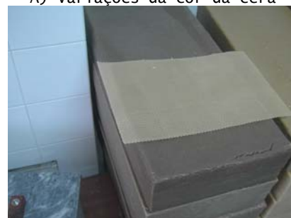
B) Variação da cor da mesma cera devido ao processo de decantação
