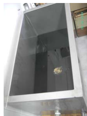
Figura 19. Recipiente em inox para decantação da cera
