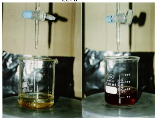
B) Determinação do índice de acidez Figura 15. Determinação de parâmetros físico-químicos
